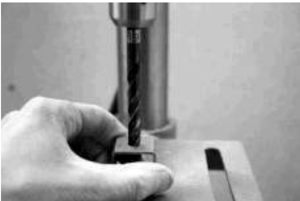
Drilling the die holes.
